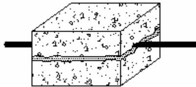
Figura 35.4 – Fendilhamento longitudinal do concreto
