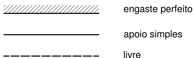
Figura 9 – Convenção de estilo de linha para os vínculos engaste perfeito, apoio simples e borda livre.
