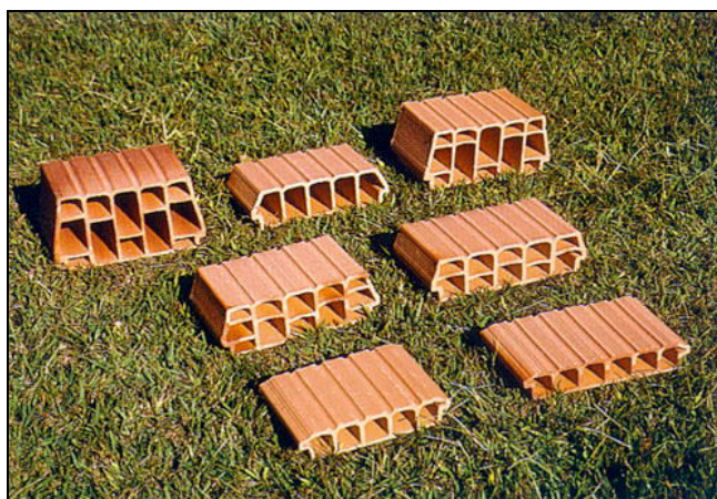
Figura 81 – Bloco cerâmico de enchimento (FAULIM, 1998).
