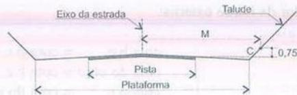
Figura 6.29 Visibilidade na curva horizontal – seção.
