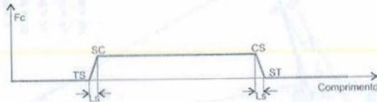
Figura 4.6 Força centrípeta em curva com transição insuficiente.
