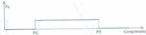
Figura 4.5 Força centrípeta em curva circular.
