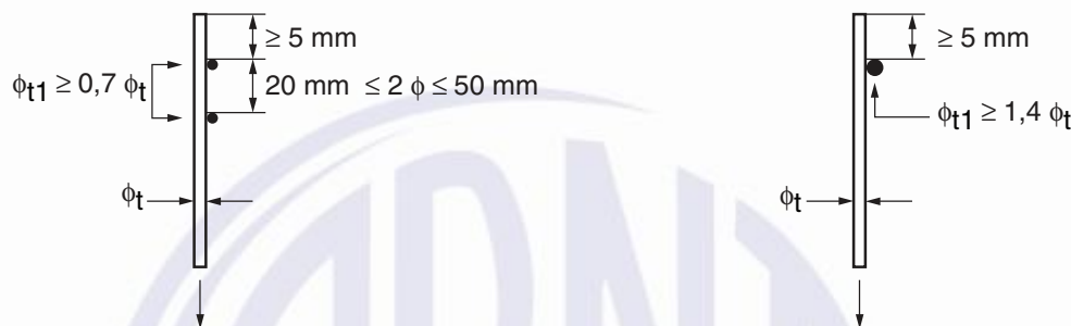
Figura 9.2 – Ancoragem de armadura transversal por meio de barras soldadas
