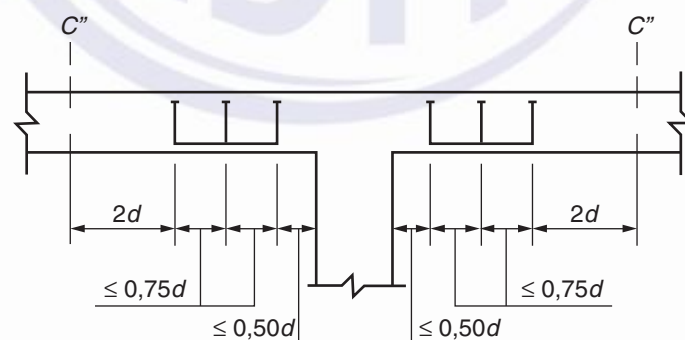
Figura 19.9 – Disposição da armadura de punção em corte
